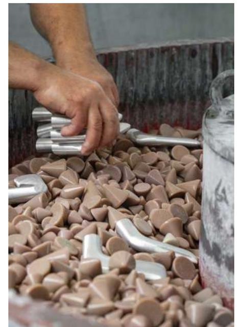
Nach dem Auskühlen wird die Güte des Gusses kontrolliert, der Anguss entfernt und der Wiederverwertung zugeführt, der Rohling händisch geschliffen und zur Oberflächenveredlung weitergereicht.
