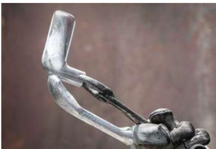
In Trowalisiertrommeln entsteht die für FSB typische Akkuratess: Radien und Kanten erfahren eine behutsame Bearbeitung mittels kleiner Keramikkegel. Je nach Kundenwunsch wird die Oberfläche abschließend poliert, gestrahlt und bei farbigen Modellen eloxiert oder pulverbeschichtet.
