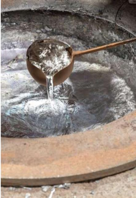
Unser Qualitätsanspruch lässt sich beispielhaft an einem über Jahrzehnte perfektionierten Verfahren veranschaulichen, bei dem Produkte aus 660 Grad Celsius heißem Aluminium gegossen werden. Das Leichtmetall wird mit einer Schöpfkelle entnommen und mittels Kokillenschwerkraftguss in Form gebracht. Dabei füllt das Aluminium den formgebenden Hohlraum allein durch Schwerkrafteinwirkung.
