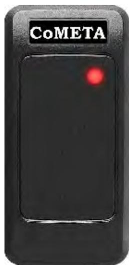
Lettores RFID di prossimità indoor/outdoor (IP65) di carte e tags a 125 kHz standard ISO11784/85. Formato di uscita Wiegand 26 bits con tamper anti-rimozione, buzzer interno e LED per la segnalazione della lettura per l'utente finale.
