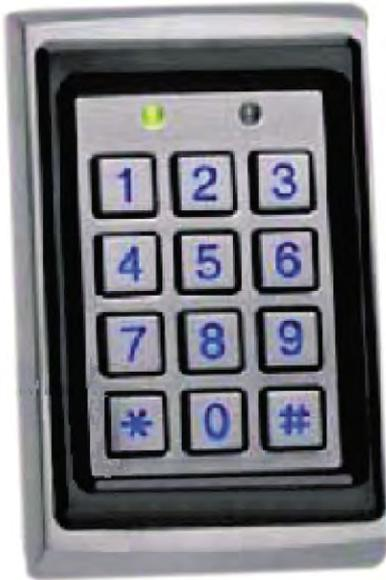
Tastiera e reader MIFARE 13,65 MHz standard ISO14443 Type A antivandalo indoor/outdoor (IP65) con tasti retroilluminati. La tastiera reader è collegata tramite formato di uscita Wiegand 26 bits con una centrale di controllo e trasmette i codici PIN fino a 6 cifre. Include tamper anti-rimozione, buzzer interno e LED a tre colori per la segnalazione dello stato / programmazione per l'utente finale. L'identificazione dell'utente non è supportata con doppia sicurezza PIN+BADGE.
