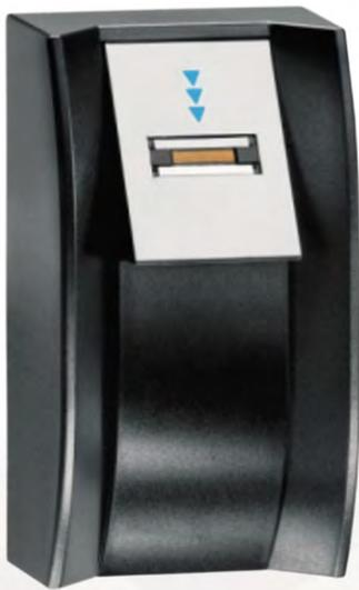
Lettoce biometrico di impronta digitale + lettore di prossimita' di carte MIFARE. Il sistema utilizza un lettore biometrico a strisciamento: nella carta MIFARE possono alloggiare fino a 2 impronte. Il sistema verifica l'esatta corrispondenza fra l'impronta memorizzata nella carta e quella rilevata dal lettore.
