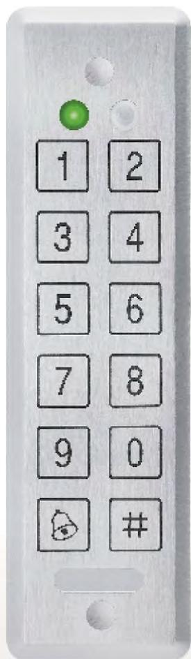
Tastiera antivandalo ultra-slim con tasti piezoelettrici indoor/outdoor (IP68). La tastiera funziona in modalità reader collegata tramite formato di uscita Wiegand 26 bits con una centrale di controllo e trasmette i codici PIN fino a 6 cifre. Include tamper anti-rimozione, buzzer interno e LED a tre colori per la segnalazione stato / programmazione per l'utente finale.
